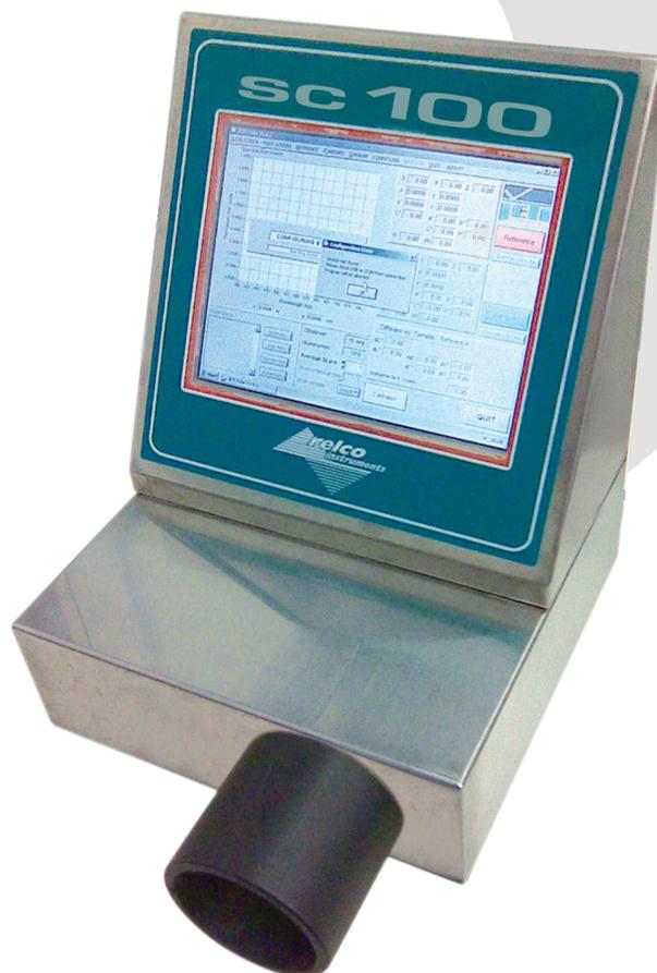
Lo spettrocolorimetro SC100 è stato progettato dalla Relco Instruments dopo anni di ricerche e sviluppo nel campo delle misure colorimetriche applicate al mondo vinicolo.
